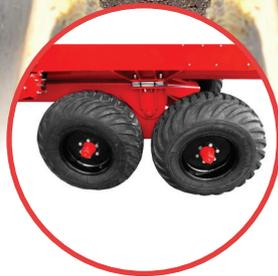
Rodado tándem con neumáticos de alta flotación, lo que facilita los trabajos en terrenos irregulares.
