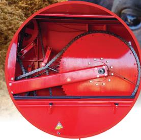
Transmisión sobredimensionada y bañada con aceite, con tensores presionados por muelles, para mantener las corrientes siempre estiradas en la medida cierta.
