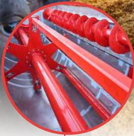
Compartimento de mistura fabricado em aço inoxidável e tombador equipado com um sistema de alívio, com molas para prevenir sobrecargas, reduzindo assim a necessidade de esforço e otimizando o consumo de combustível.
