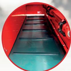
Descarga por cinta transportadora en PVC, permitiendo excelente distribución de fibras cortas y largas.
